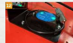
角度センサー：高所作業車が斜面を昇降および移動する際に、センサーは機械の状態を自動的に判定し、もし角度が定格角度を超える場合はオペレーターに警告を発します。
