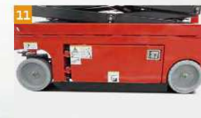
脱輪防止システム：機械が2m以上に上昇すると、このシステムが自動的に作動し、不平等な地面での移動中に機械の脱輪を防止します。
