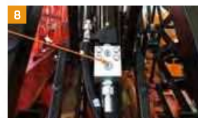
防漏バルブ：オイルパイプの漏れによる機械の落下を防止します。
