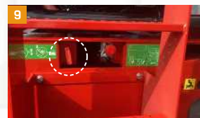
緊急降下バルブ：システムの故障や電力が不足した場合、作業床を緊急降下させるための対策が講じられます。
