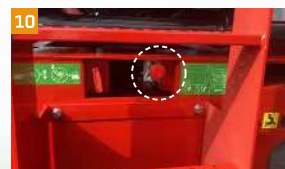
マニュアルリリースボタン：機械が動かない場合、ボタンを押すことで機械を押し動かすことができます。
